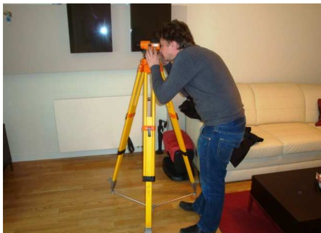
Rys. 4. Pomiar poziomu sufitu nad mieszkaniem za pomocą niwelatora optycznego
